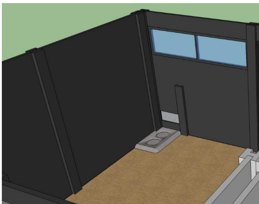
Rys. 11. Wiata dla wilków – wewnątrz (2 pomieszczenia oddzielone podwójną ścianką), w rogu platforma betonowa do karmienia.
