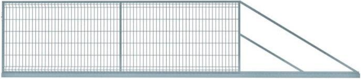
Rys. 21. Brama przesuwna (wymiar wg. projektu)
